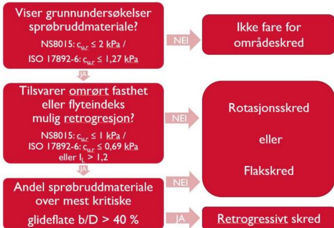
Figur 8: Identifikasjon av skredmekanisme
