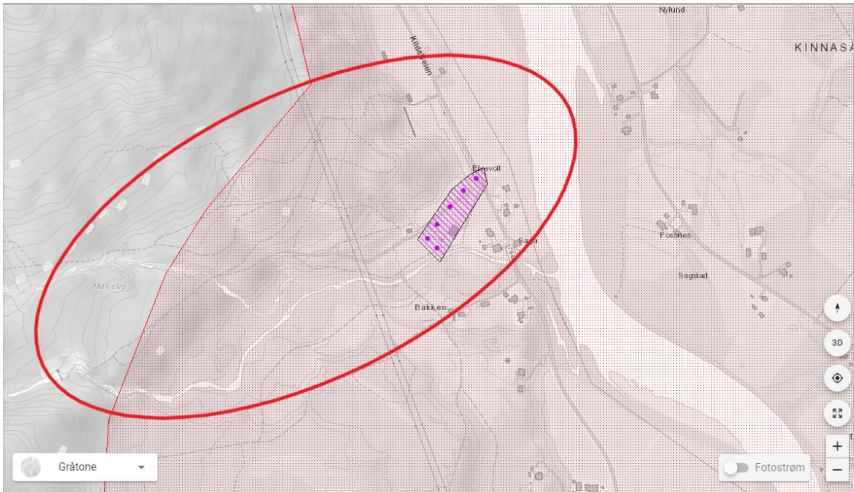
Figur 3 Faresone for kvikkleireskred, områder der det er påvist kvikkleire ved tidligere undersøkelser markert med lilla polygon og punkter.
