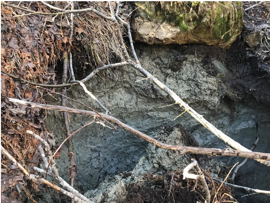
Figur 10: Nærbilde av utglidning i kohesjonsjordart. Foto: Arktisk Geotek AS.
