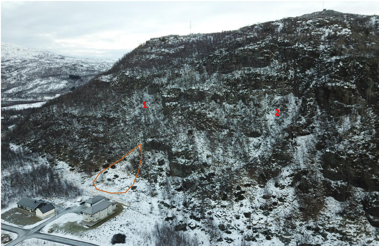
Figur 10: Løsneområder for snøskred i den sørøstvendte fjellsiden like nord for kartleggingsområdet. Dråpeformen vist med brunt polygon viser kartlagt vifteformasjon etter grunn løsmasseutglidning.
