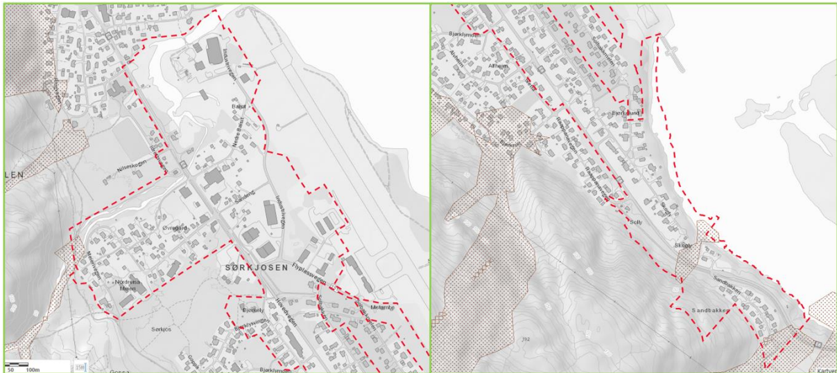
Figur 17: Utsnitt som viser NVEs aktsomhetsområder for jord- og flomskred med brun skravur. Plangrense markert med rød stiptet linje. (Kilde: NVE Atlas)
