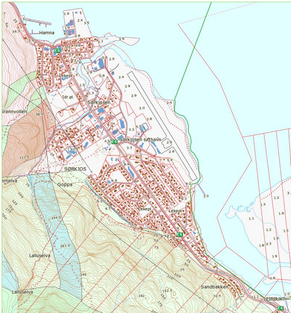
Figur 13: Berggrunnskart. Lys grå = Morene, grus, sand og leire. Lys grønn = Gråvakke. Grønn = Leirskifer og siltstein. Rosa = Granodiorittisk gneis med pegmatitt- og abfibolittlinser. Brun = Grønnstein. Blå = Dolomitt og kalkstein. ( http://geo.ngu.no/kart/berggrunn/ )
