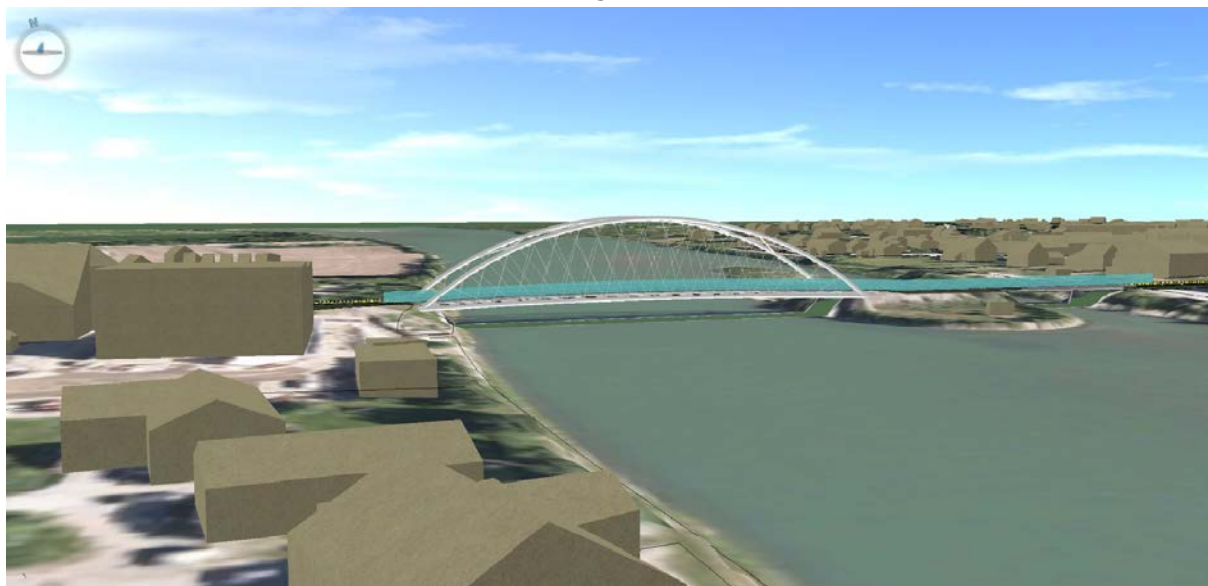
Figur 8 Nettverksbuebru, illustrasjon: ÅF Engineering
