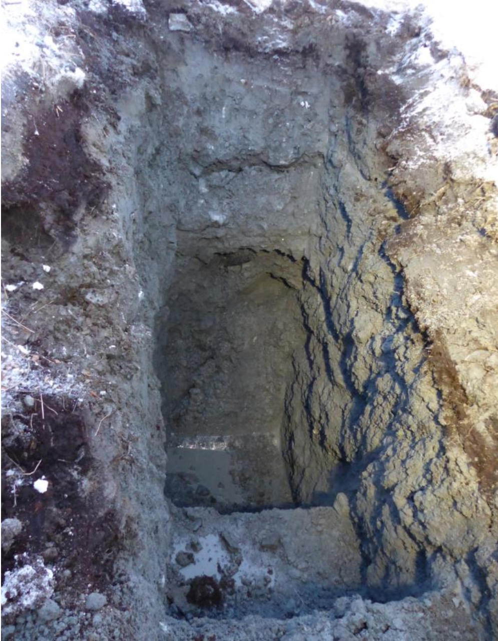
Bilde av prøvegropp lokalisert i bakkant av planlagt verkstedhall, se bilag 2 for plassering.
