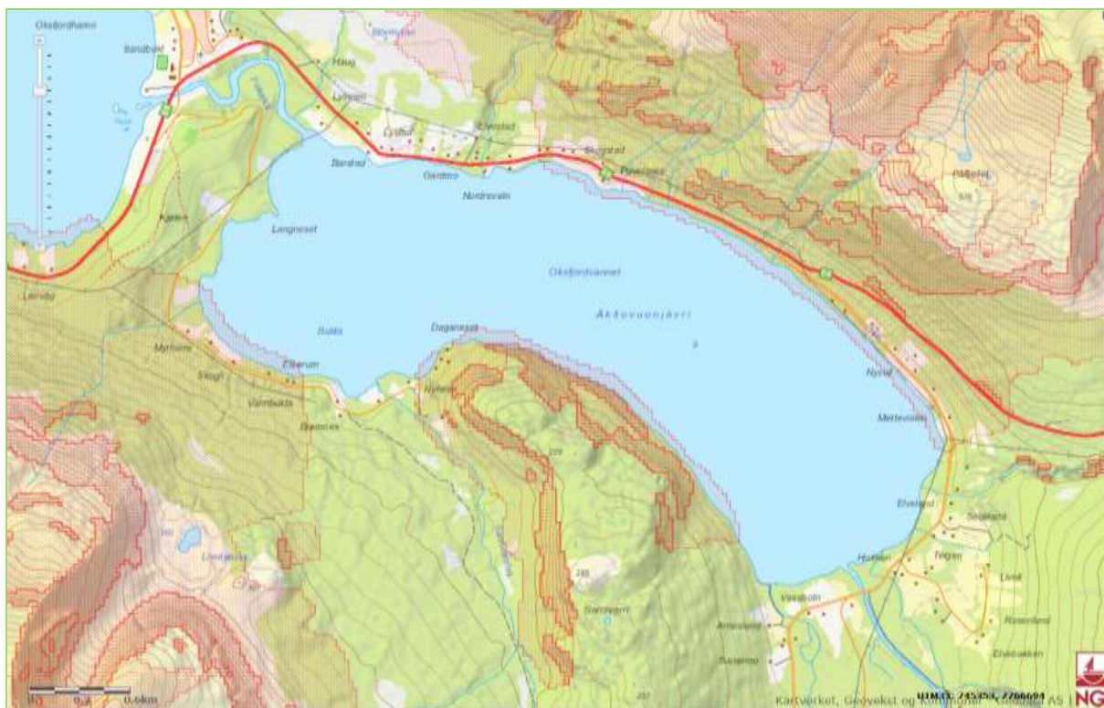
Figur 5: Kartutsnitt fra NGIs skredkart. Mørkest rødt skraverte områder er utløsningsområder for skred. Lysest rødt skraverte områder er utløpsområder for skred.
